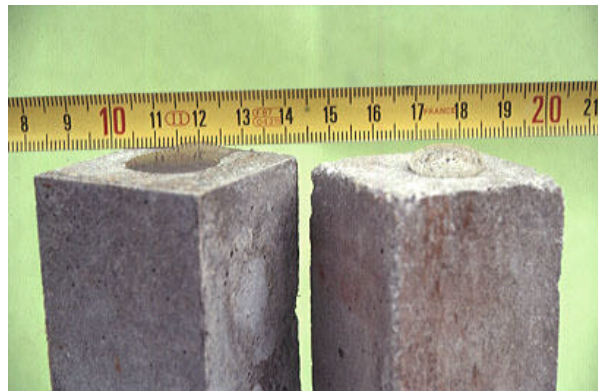
Fig. 2 - Provini di malta da intonaco trattati (a destra) e non (a sinistra) con idrorepellente a base silanica.
